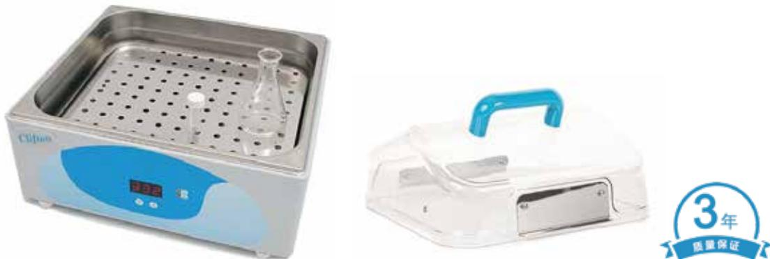
Clifton® ShallowBaths™ 系列浅槽水浴，加热温度最高达99°C，专为微量或小型容器而设计，内槽高度65mm，有2升、5升、9升三种容积。外壳表面采用独特的抗菌技术，可有效抑制细菌生产且易于清洁，一体成型的优质不锈钢内槽，高精度微电脑PID温度控制器和特殊硅橡胶SCS加热技术。加热模块隐藏覆盖于浴槽外部，方便清洁槽内卫生，易于维护，实现槽内空间最大化。
